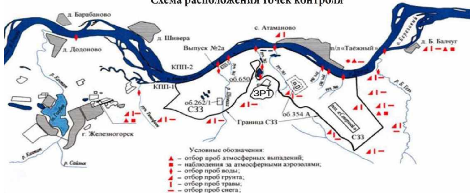
Рис. 4.7.1 Карта-схема расположения постов контроля и пунктов отбора проб объектов окружающей среды в санитарно-защитной зоне и зоне наблюдения ФГУП «ГХК»
